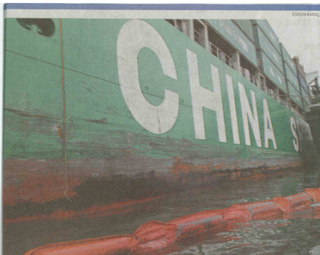
A colocação de barreiras na área em torno da embarcação impediu a dispersão do produto no canal
